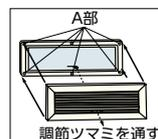
室内カバーの穴から調整ツマミを出し、室内カバーのA部(6か所)がパチンと音がするまで本体に押し込みます。
