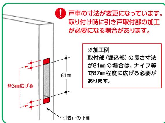
❗ 戸車の寸法が変更になっています。取り付け時に引き戸取付部の加工が必要になる場合があります。
