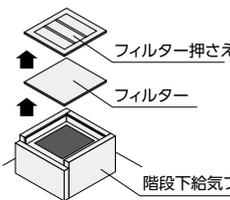
フィルター押さえをもち上げ、フィルターを交換します。
