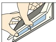
安定した踏台などにのり、室内カバーの左右片側ずつ図のように下端に親指を掛け、めくるように手前に引っ張るとはずれます。
