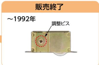
❗ 建築年が1992年以前の場合は、高さ調整付戸車 (P1503) 取り付け時に新しい調整ビスの位置に穴をあける必要があります。
