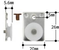
❗ はずれ止めの高さ寸法 (○部) が建築年により異なります。どちらの部品かご確認ください。
