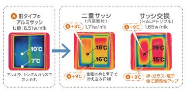
※測定:YKKAP価値検証センター(測定条件:外温度0度/室内20度)
